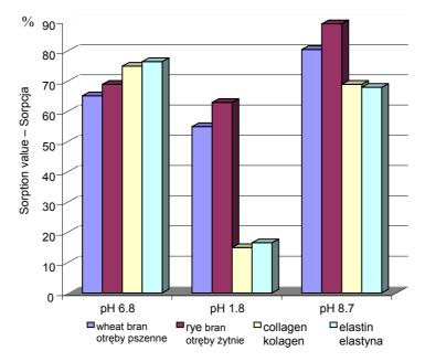
Fig. 1. Sorption of zinc by various bran and collagen and elastin preparations Ryc. 1 Sorpcja cynku przez preparaty kolagenu i elastyny
